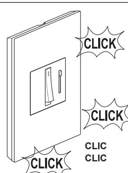
Enclencher la plaque murale dans le boîtier. Trois arrêts par enclenchement sont disponibles pour permettre de choisir l'alignement de la plaque murale avec la surface frontale du variateur.
