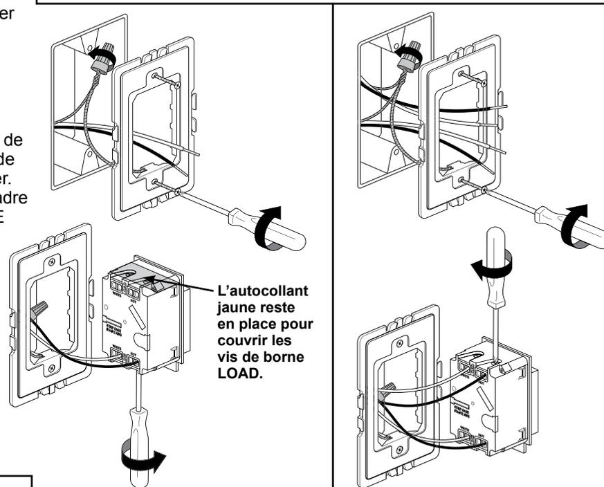
L'autocollant jaune reste en place pour couvrir les vis de borne LOAD.
