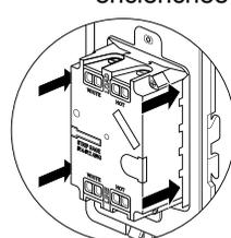
**REMARQUE** – Si vous avez besoin de retirer la sortie après l'avoir enclenchée dans le cadre, ôtez d'abord le cadre du boîtier mural pour accéder aux quatre ergots de verrouillage au dos de la sortie. Insérez un tournevis plat pour enfoncer les ergots en appliquant une pression afin de dégager la sortie.
