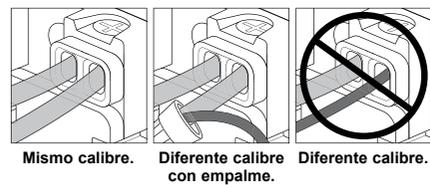
Mismo calibre. Diferente calibre con empalme. Diferente calibre.
