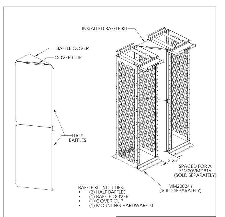
BAFFLES ARE UL94V-0 RATED **EXPANDED FOAM PVC**
