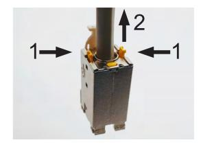
SQUEEZE LACING CAP SIDE LATCHES IN TOWARDS THE CABLE, PULL CABLE AND LACING CAP AWAY FROM JACK BODY.
