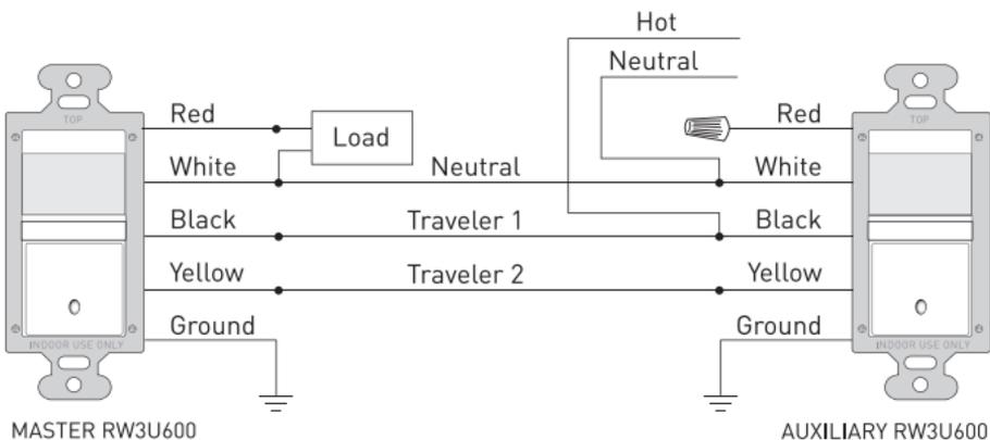
**Fig. 5: Reference wiring diagram**
