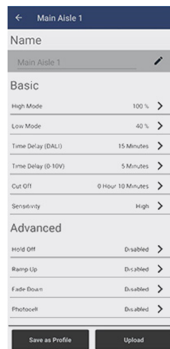
Example of parameters for 01-10V wiring
