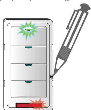
En mode PnL avec le LMPS en réseau local, tous les périphériques sont déconnectés (DEL bleues désactivées) et doivent être sélectionnés, puis raccordés aux charges appropriées.
