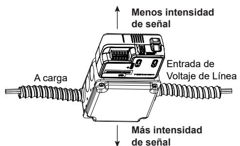
Todo el cableado de tensión de la línea es #16 AWG. El relé está homologado para un máximo de 10 A; la carga total del LMRC-611MCC no deberá exceder los 10 A. Las cargas de Encendido/Apagado o de atenuación de entre 0 y 10 V pueden conectarse a cualquier relé de carga.
