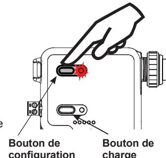
**NOTE:** Répétez les étapes 2 et 3 pour chaque détecteur et interrupteur de la pièce, pour que tous les dispositifs soient couplés sur le même réseau. Pour chaque dispositif, la charge s'active à l'étape 3. Sa DEL de configuration passe au vert fixe.
