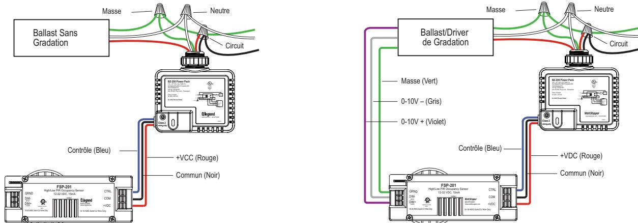
**REMARQUE:** Le FSP-201 doit être mis à la terre pour garantir l'intégrité du signal et non pour une mise à la terre de sécurité.
