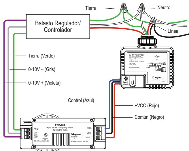
**NOTA:** FSP-201 debe estar conectado a tierra para garantizar la integridad de la señal, no por cuestiones de seguridad.
