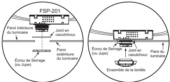
**REMARQUE:** Une jupe (optionnelle) peut être installée à la place de l'écrou de serrage. Pour les détails, voir la table d'information de commande à la page 8.
