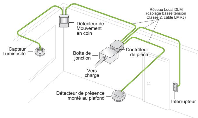
**ATTENTION : POUR CONNECTER UN ORDINATEUR AU RÉSEAU LOCAL DLM, UTILISER LE LMCI-100. NE JAMAIS CONNECTER LE RÉSEAU LOCAL DLM À UN PORT ETHERNET – CELA POURRAIT ENDOMMAGER LES ORDINATEURS AINSI QUE LE MATÉRIEL CONNECTÉ.**
