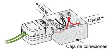
En el interior de una caja de conexiones de 11,9 cm x 11,9 cm (4-11/16 po x 4-11/16 po)
