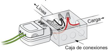
En el interior de una caja de conexiones de 11,9 cm x 11,9 cm (4-11/16 po x 4-11/16 po)
