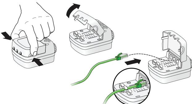
Quite las cubiertas de goma si usa los 3 receptáculos RJ45. Deje las cubiertas en su lugar para todos los receptáculos no utilizados
