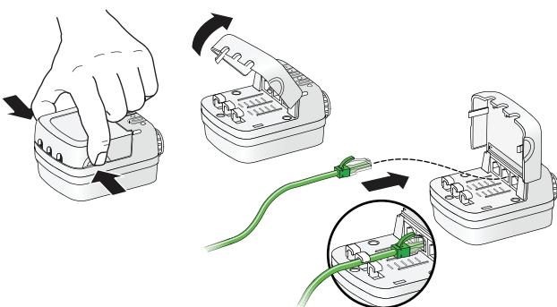
Retirer les protecteurs des connecteurs femelles en caoutchouc si les 3 prises RJ45 sont utilisées. Laisser les protecteurs en place pour toutes les prises non utilisées.
